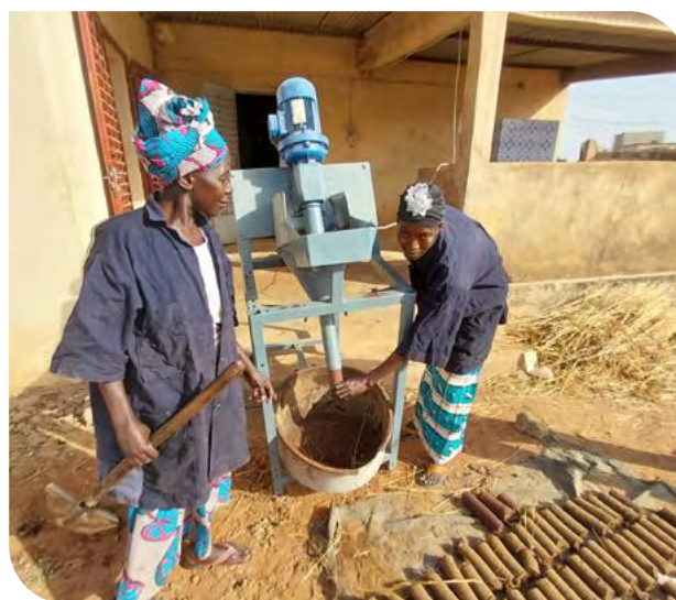
Femmes employées à la Coopérative YIRIWASSO au Mali pour la fabrication de briquette à base de boue de karité.
